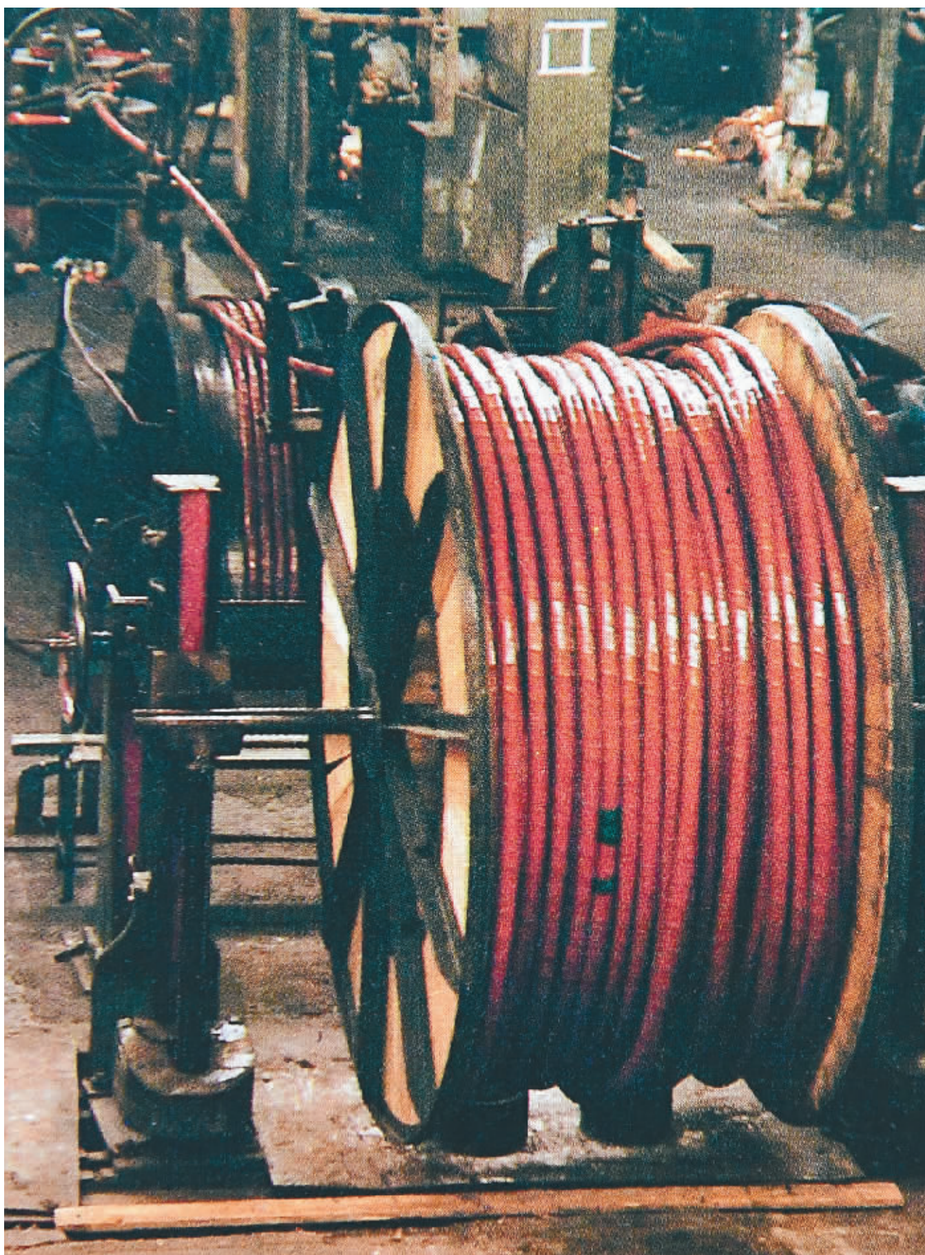
当年沈阳电缆厂的装铠工艺
